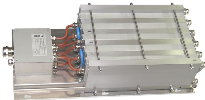
Dall'immagine si può vedere che vi sono sei moduli di resistori che sono collegati attraverso passacavi EMC a una scatola morsetti centrale. Interposti fra i resistori vi sono quattro moduli per il raffreddamento ad acqua e l'intero complesso è montato insieme e fissato su una piastra di base utilizzando piastre laterali e bulloni.
