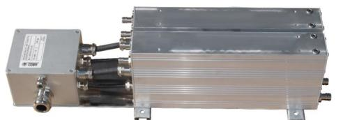
L'esempio mostrato in figura è un resistore doppio REO raffreddato ad acqua - tipo BW D 158, forma costruttiva BF2 – che può dissipare fino a 10 kW di potenza. Un maggior numero di unità multiple che utilizzano questa tecnologia - ad esempio 4 x BF3 - possono dissipare fino a 60 kW di potenza.
