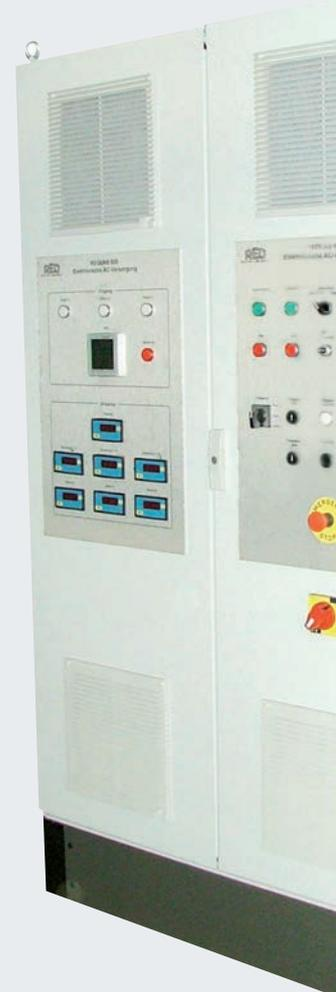
L'impianto preleva l'energia dalla rete di alimentazione, che raggiunge la potenza desiderata grazie al modulo di alimentazione CA/CC. Invece del carico resistivo, il dispositivo sotto prova può essere sollecitato tramite tre principi a risparmio energetico.
