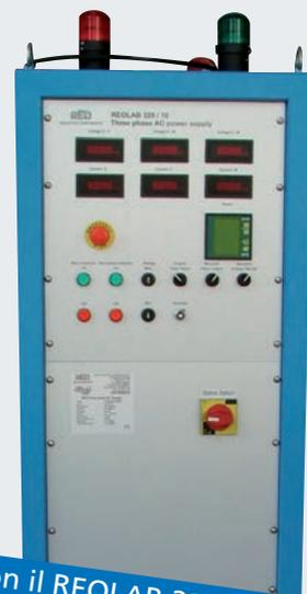
In abbinamento con il REOLAB 220 come sorgente di corrente elevata per prova di riscaldamento, REOLAB 320 può essere impiegato per la prova d'isolamento di cavi e terminali di cavi
